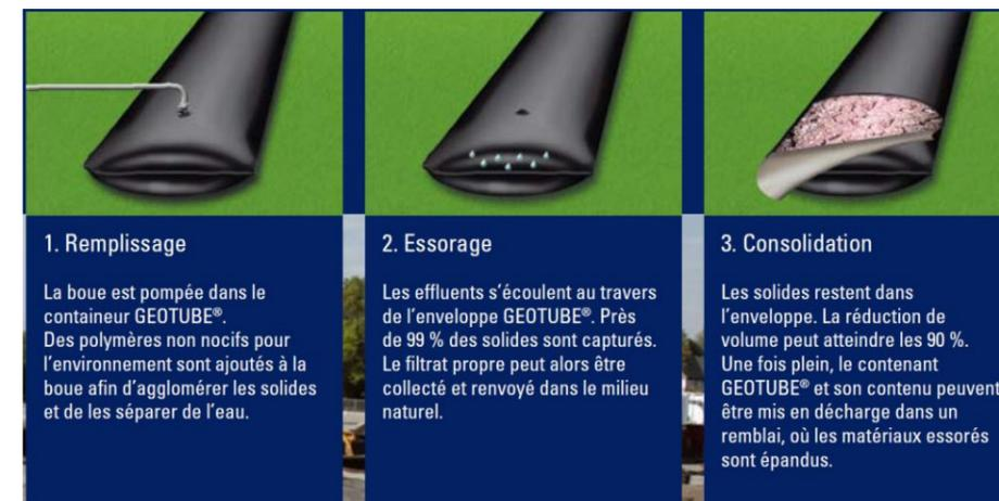
Figure 34 : Principe général de fonctionnement des géotubes (source : [www.tencategeotube.com](http://www.tencategeotube.com)).
