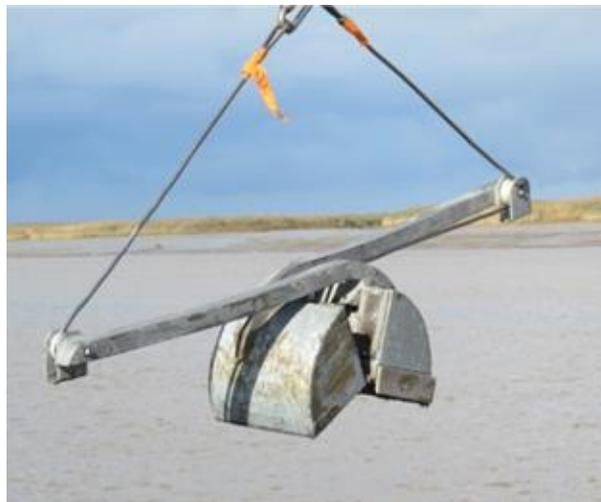
**Figure 2 : Benne Van Veen**
