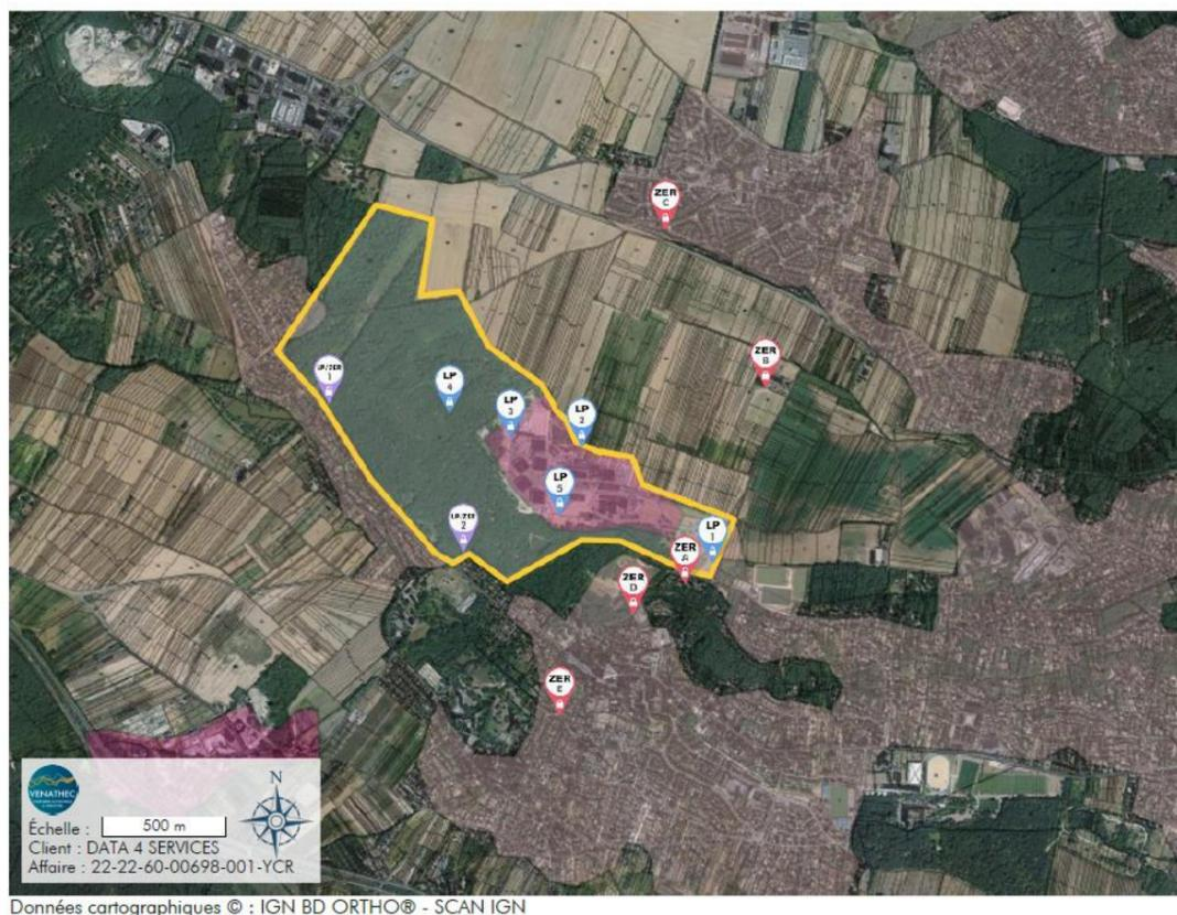
Figure 55 - Plan de la situation sonore (source : Rapport de mesures acoustiques N°22-22-60-00698-001-YCR - VENATHEC du 24/08/2022)
