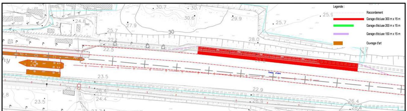
**Figure 21 : Scénario B d'implantation du garage d'écluse à l'amont de Cuinchy retenu pour la phase AVP à l'issue du CMOA du 17/05/2022**
