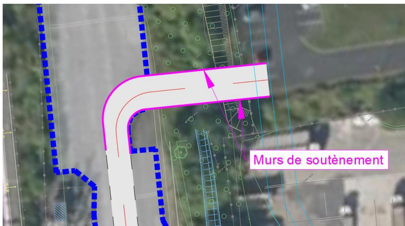
Figure 7 : Ouvrage de soutènement à la sortie du parking
