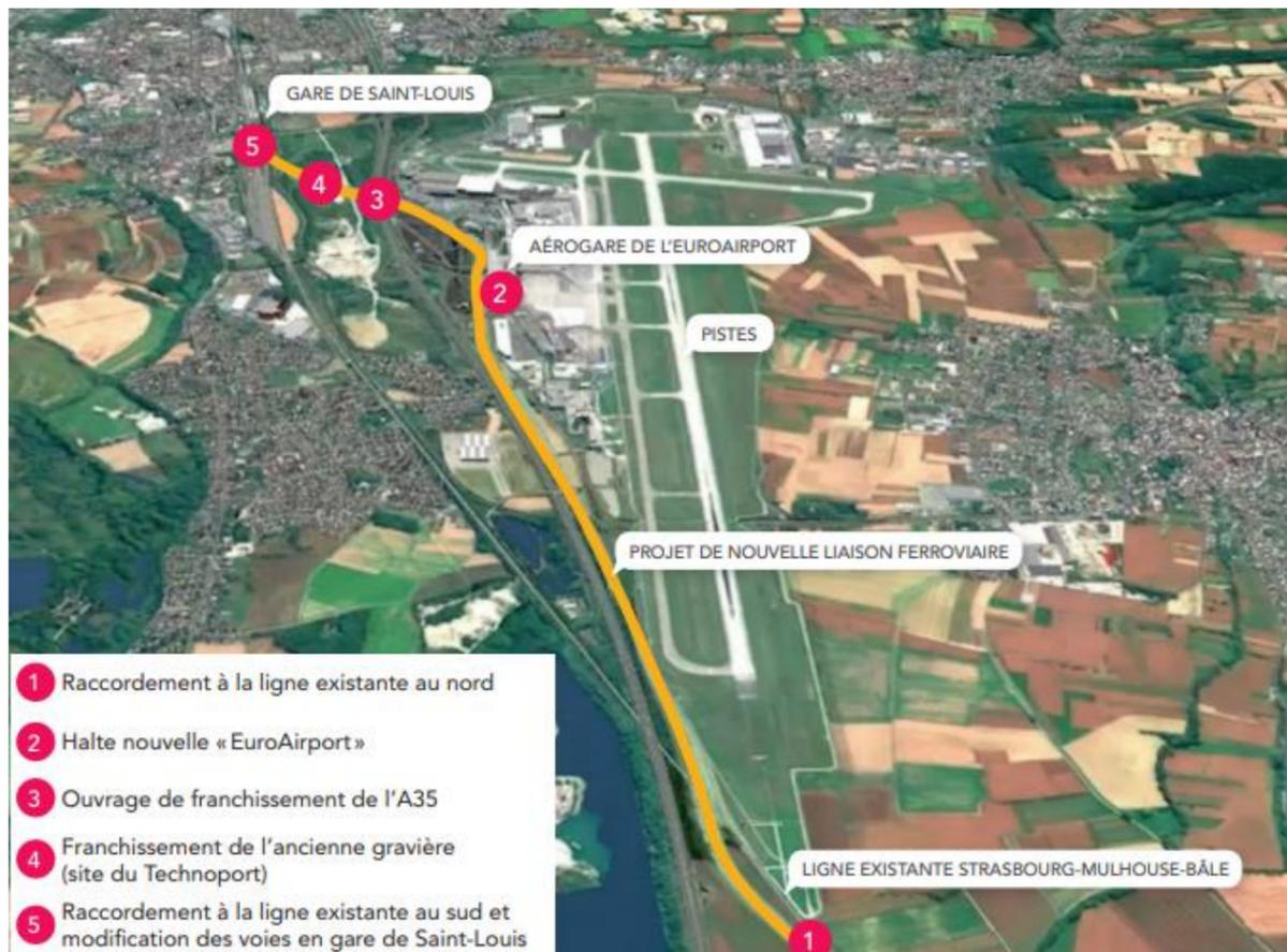
Figure 31 : Tracé de la nouvelle voie ferroviaire (source : dossier de concertation du projet NLF, 2018)
