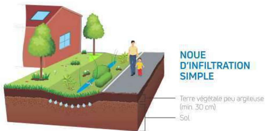
FIGURE 34 : NOUE D'INFILTRATION SIMPLE
