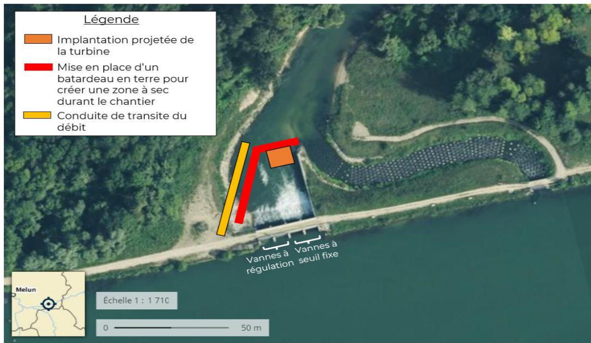
Figure 12 : Alternative de mise à sec par by-passing
