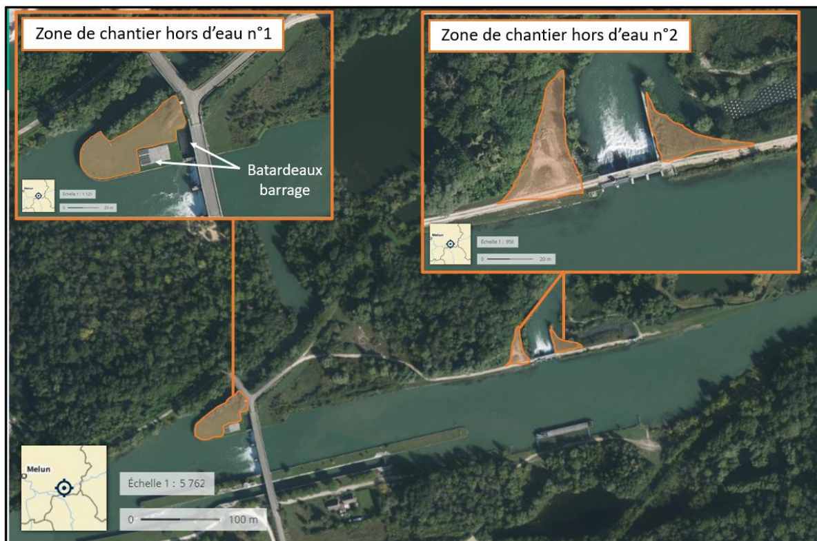
Figure 1 : Vue en plan de la localisation des zones chantier hors d'eau (Géoportail, échelle 1 / 5 762)
