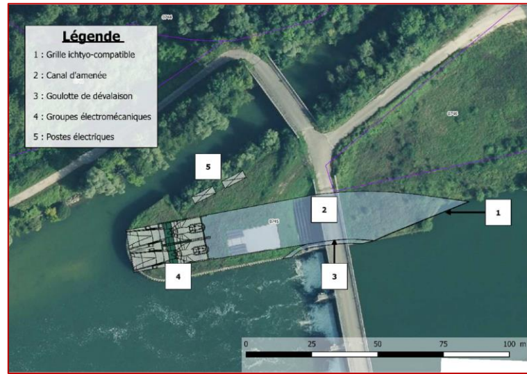
Vue en plan de la version initiale du projet hydroélectrique de Grande-bosse présenté à l'appel d'offres de la CRE en mai 2020 (Source : Plan VALOREM)
