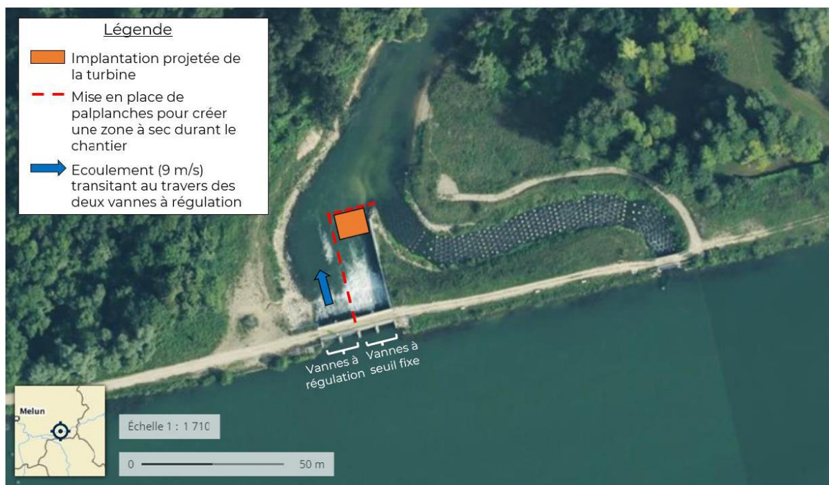
Figure 10 : Alternative de mise à sec de l'ORD grâce à la mise en place de palplanche
