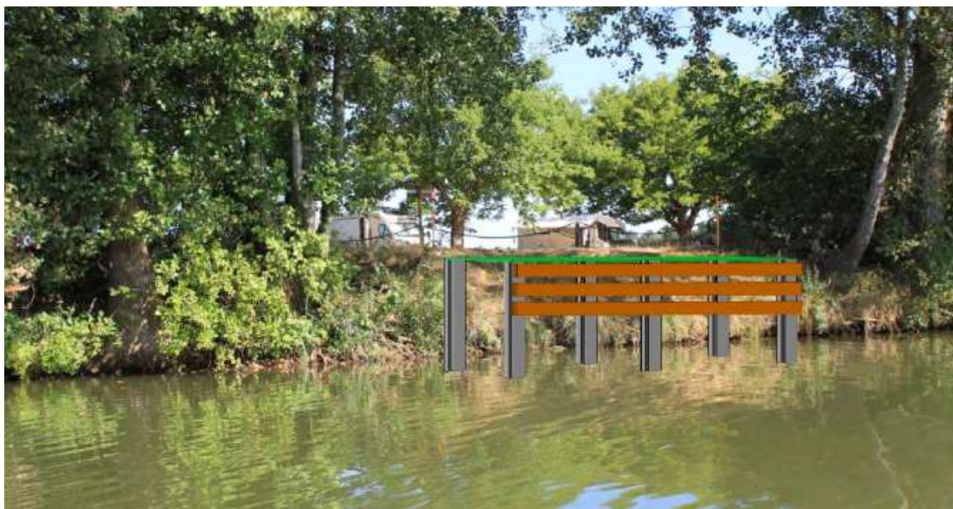
Figure 5 - Vue 3D du ponton amont. L'emplacement a été défini pour que le ponton soit installé au niveau d'une trouée d'arbres afin de ne pas impacter la ripisylve.
