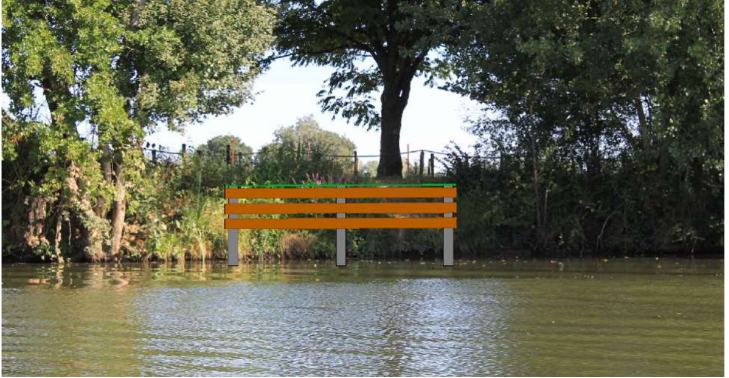
Figure 6 - Vue 3D du ponton aval. L'emplacement a été défini pour que le ponton soit installé au niveau d'une trouée d'arbres afin de ne pas impacter la ripisylve.
