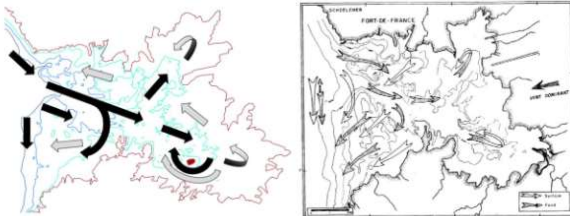
Figure 55 : Schéma de circulation générale déduit des simulations. Courant de la colonne et de fond (flèches noires) et courants de surface (flèches grises). Lecacheux et col., 2019, validant Castaing et al., 1986 (à droite)
