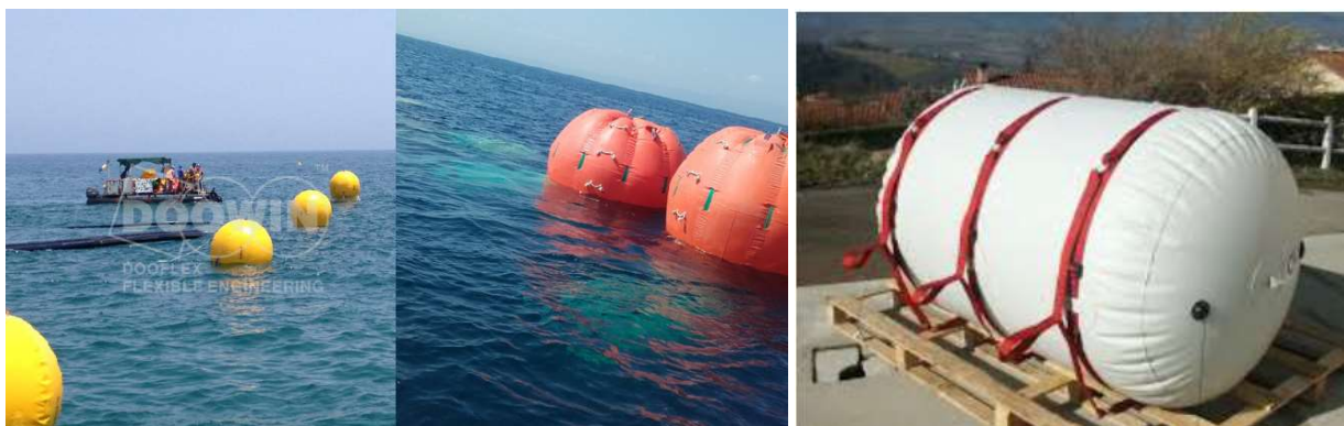
Exemples de levages sous parachutes – Photos internet – Cf MAREX pour photos libres de droits
