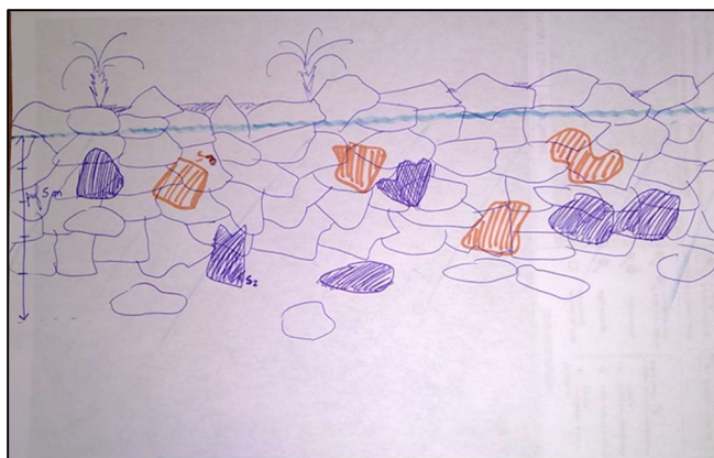
Schéma de principe de la pose en pied de digue ou incorporé dans la digue, qualité Q1 à Q3 – Digue de la Pointe de la Vierge
