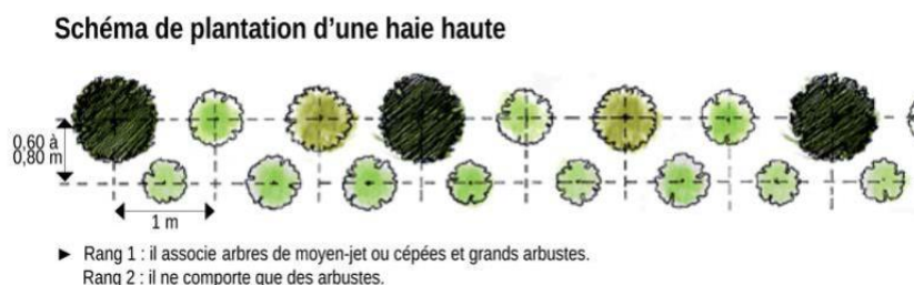
Figure 179 : Schéma de plantation d'une haie haute
