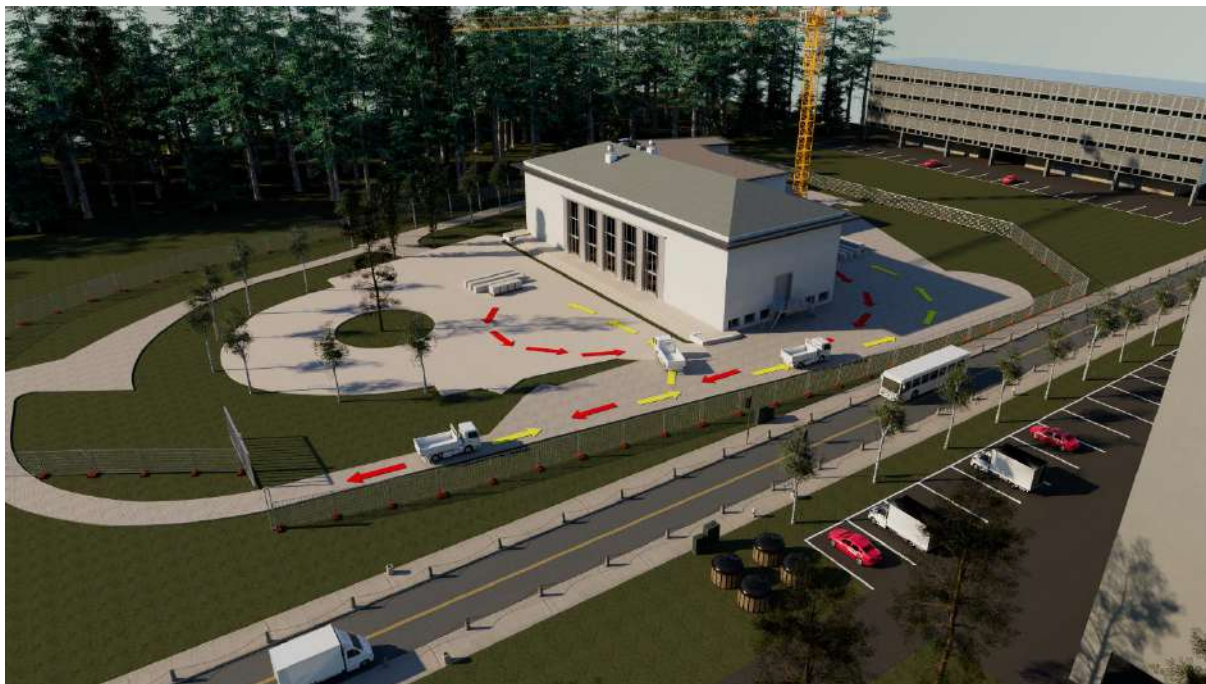
EXEMPLE DE VOIES DE CIRCULATIONS SUR CHANTIER PROCHE D'UNE ZONE BOISEE
