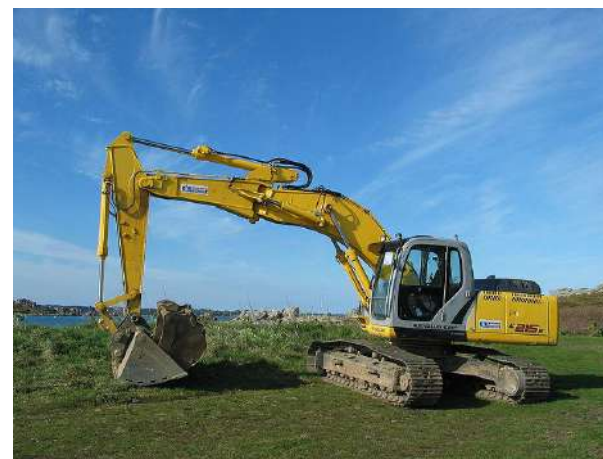
Pelle mécanique hydraulique ( https://commons.wikimedia.org/w/index.php?curid=3875087 )
