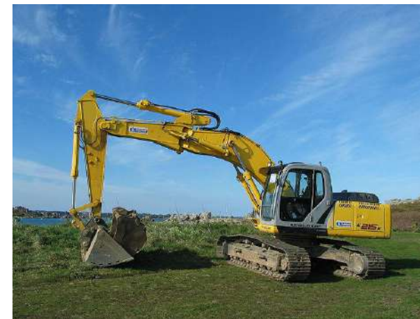
Pelle mécanique hydraulique ( https://commons.wikimedia.org/w/index.php?curid=3875087 )
