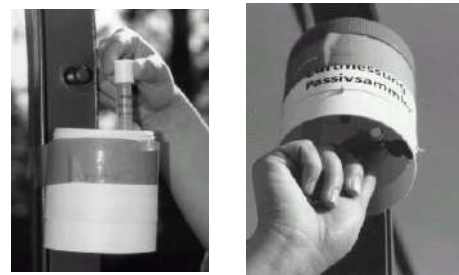
Figure 3 : Illustration de l'installation des tubes passifs NO 2 et de la boîte de protection des échantillonneurs
