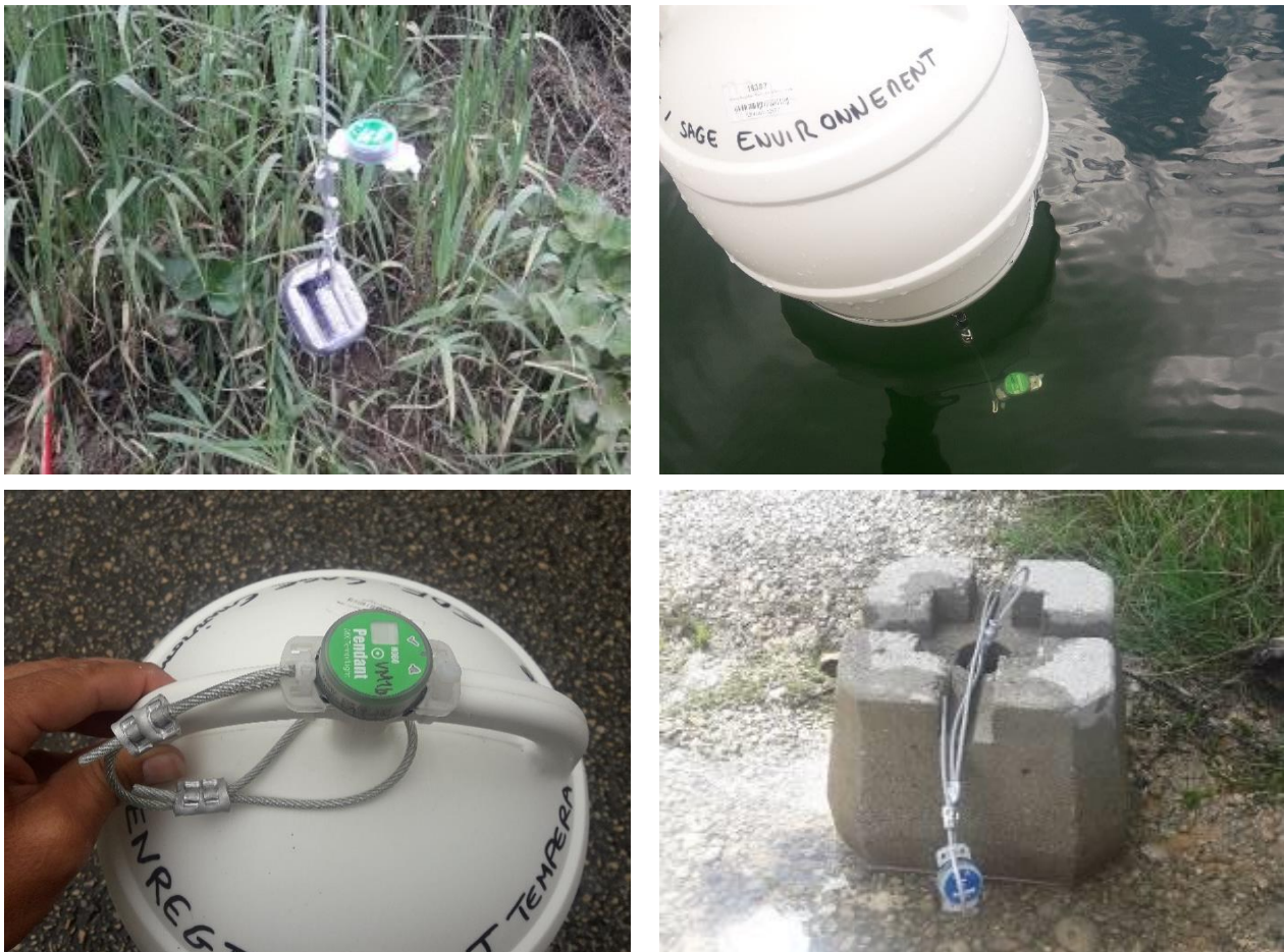
Figure 289 : Photographies du dispositif : 1 – sonde enregistreuse température et luminosité, orientée vers le haut, au-dessus du lest secondaire ; 2 – sonde enregistreuse de température et de luminosité en place sous la bouée ; 3 – sonde enregistreuse de température et de luminosité en place sur la bouée ; 4 – sonde thermique de fond, solidaire du lest principal
