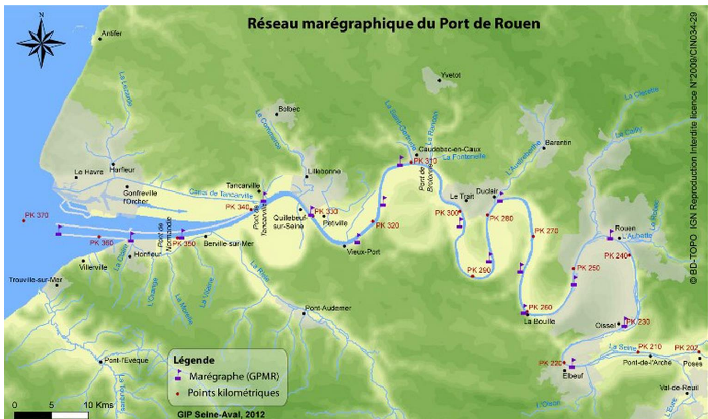
Figure 78 Carte d'instrumentation en marégraphes du tronçon Seine aval - Source DREAL Normandie
