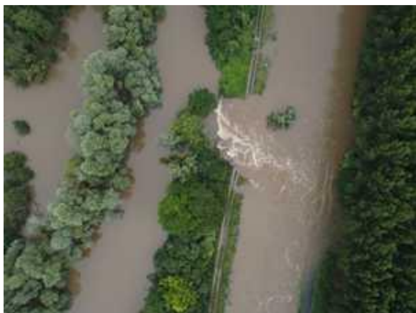
Figure 129 Département des Ardennes - brèche d'environ 29 m sur la rive droite du bief n°7 de Seuil – Source DDT 08
