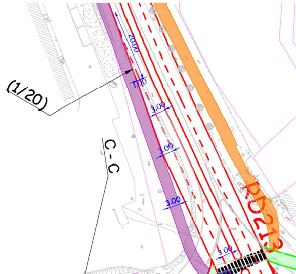
Figure 23 : Création de la seconde voie du barreau de liaison RD 213-RD13 (sens Nord – Sud)
