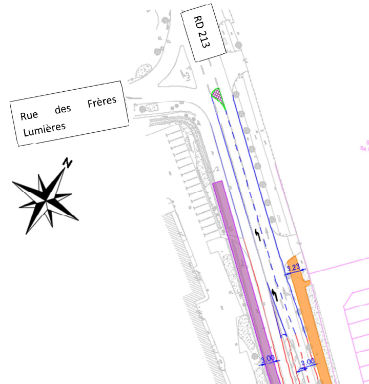
Figure 22 : Raccordement du barreau RD 213 à la voirie
