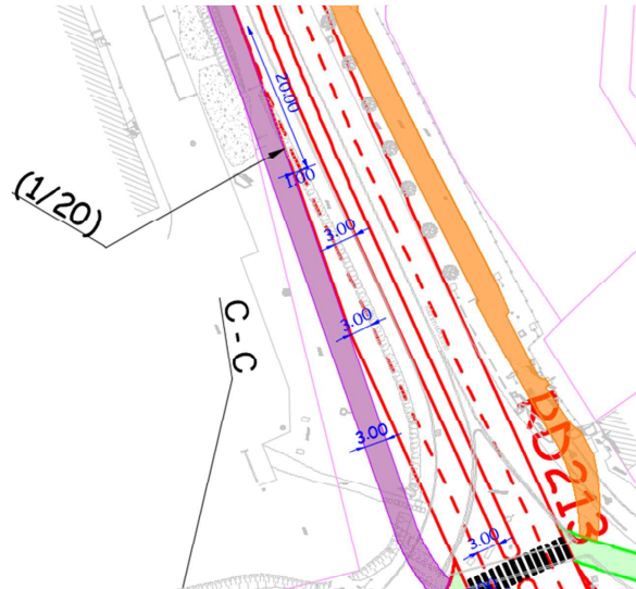
Figure 82 : Création de la seconde voie du barreau de liaison RD 213-RD13 (sens Nord – Sud)
