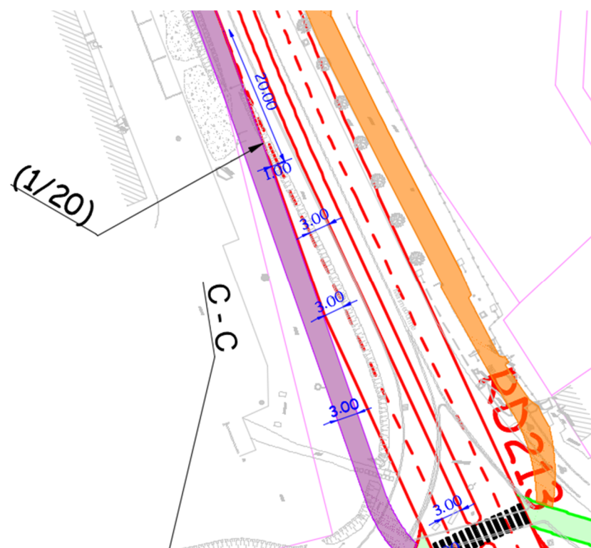
Figure 23 : Création de la seconde voie du barreau de liaison RD 213-RD13 (sens Nord – Sud)
