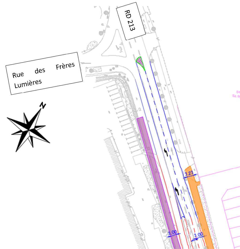
Figure 22 : Raccordement du barreau RD 213 à la voirie
