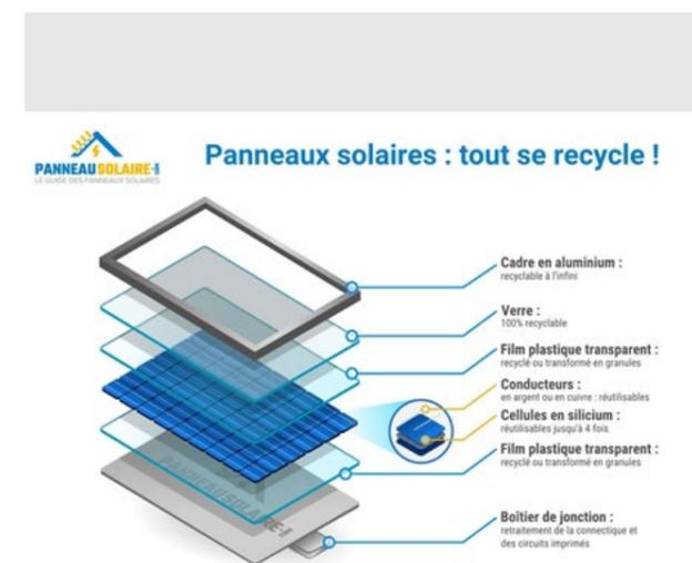
Figure 41 : Les modalités de recyclage des panneaux solaires
