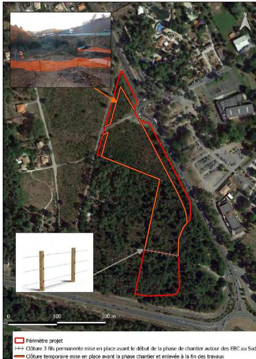
Figure 50 : Matérialisation de la mise en défens en phase chantier
