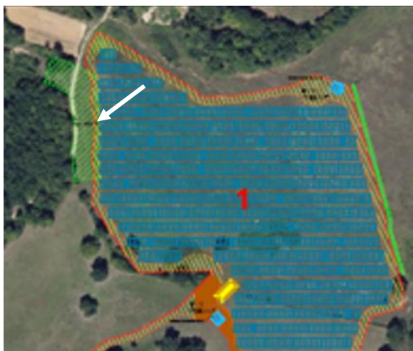
Recul des clôtures vis-à-vis des boisements
