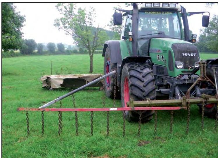
Barre d'effarouchement implantée sur un engin mécanique
