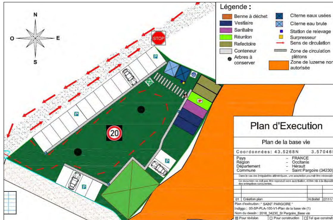
Figure 19 : Exemple de plan d'exécution d'une base-vie Source : EDF Renewables
