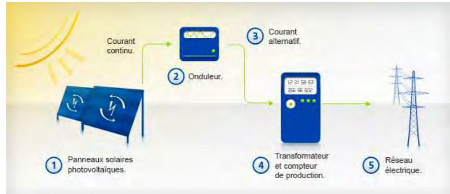
Figure 10 : Schéma descriptif du fonctionnement des modules solaires
