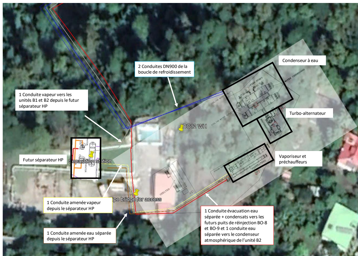
Figure 13 : Raccordements prévisionnels de l'unité B1bis aux différents réseaux de fluide géothermaux et de refroidissement
