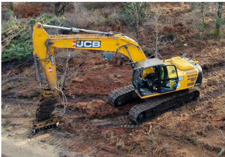
Figure 81 : Broyeur sur pelle
