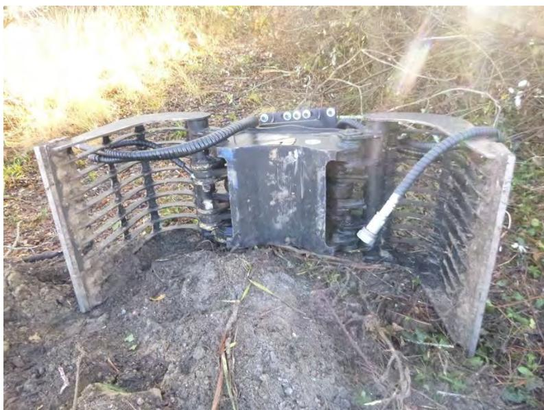
**Figure 82 : Outil pince sur pelle mécanique**
