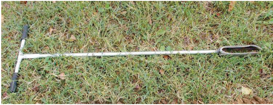
Figure 29 : Tarière utilisée pour les sondages pédologiques (SEGED)
