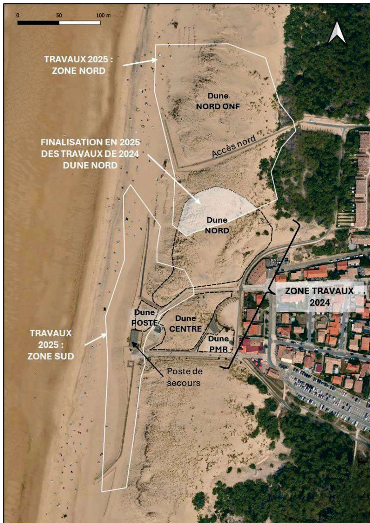
Figure 5 : Emprise des travaux de 2024 (en noir) et des travaux de 2025 (en blanc) (orthoimage de juin 2024, avec l'ancien poste de secours visible)
