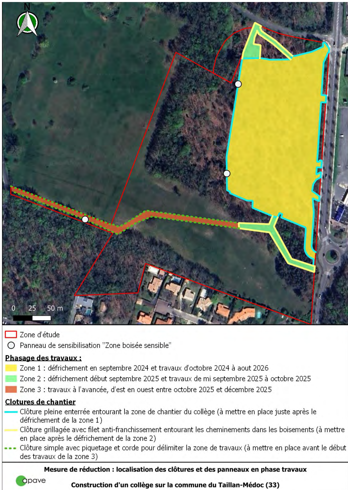
Figure 73 : Localisation des clôtures en phase chantier.
