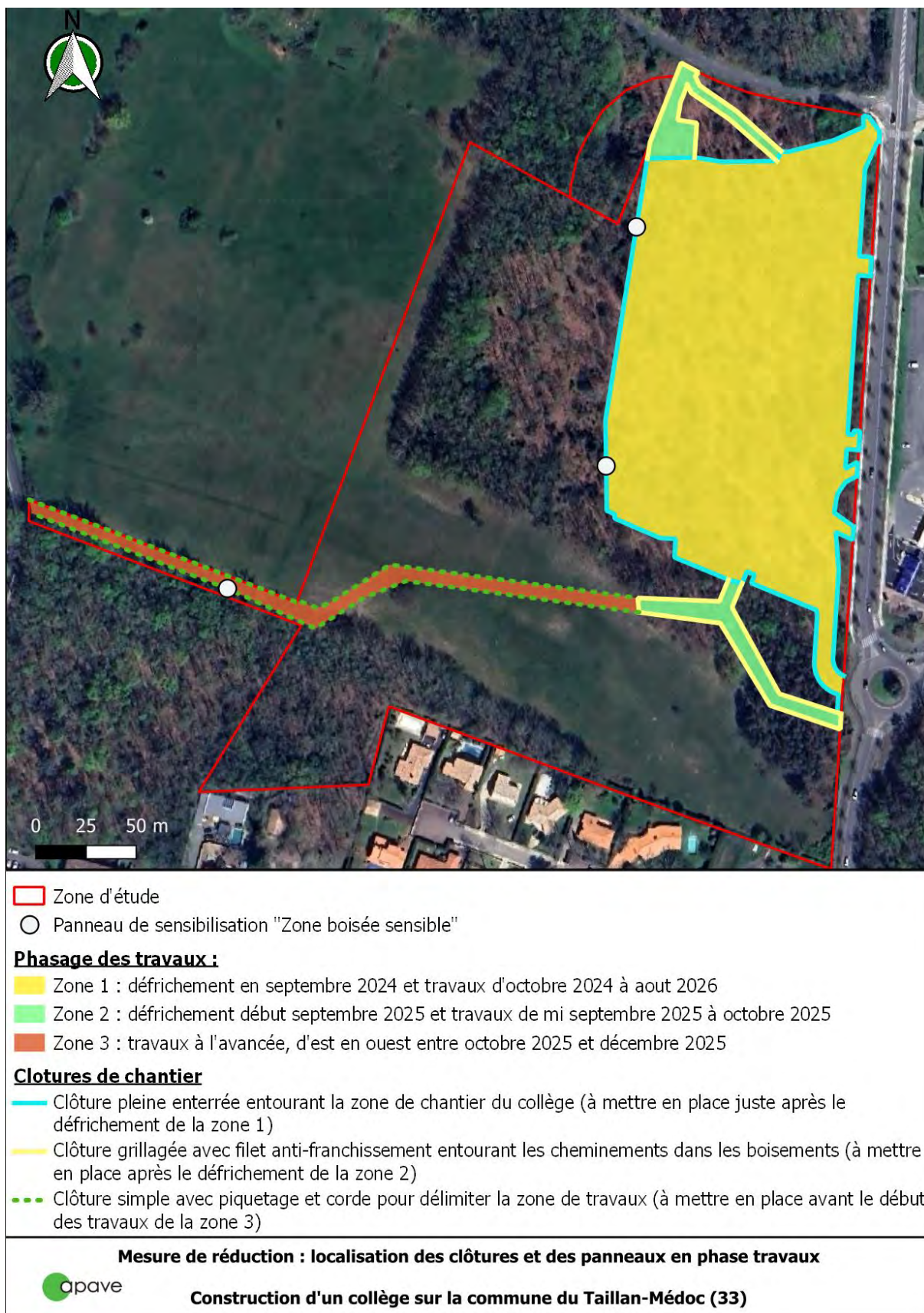
Figure 73 : Localisation des clôtures en phase chantier
