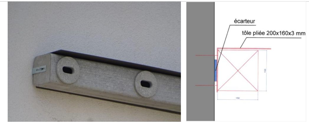
Photo 25 : Illustration de pose de nichoirs à martinet noir en l'absence d'avant-toit sur le bâtiment Sources : Martine Wauters ; BAEB
