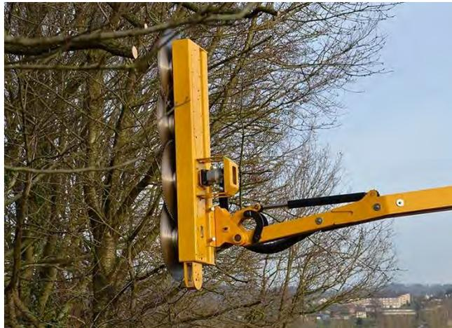
*Photo 8 : Illustration d'un lamier à scie*
