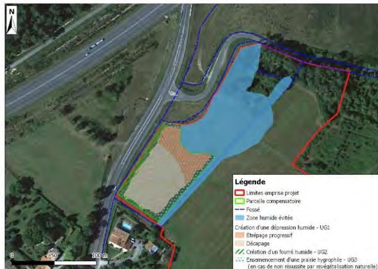
Figure 16 : Plan schématique des travaux de compensation envisagés
