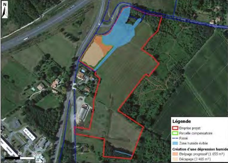
**Plan schématique des travaux de création de zone humide compensatoire**
