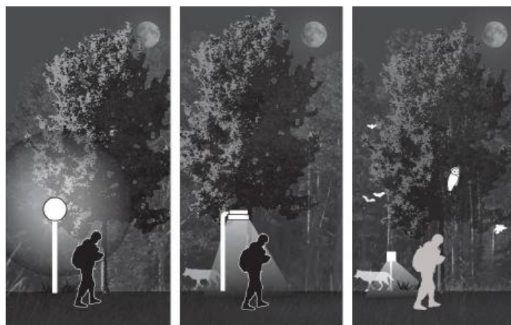
Figure 66. Plus la lumière est focalisée sur sa cible, moins elle affecte les espèces : le cas présenté à gauche est donc à proscrire – ©Longcore, 2016
