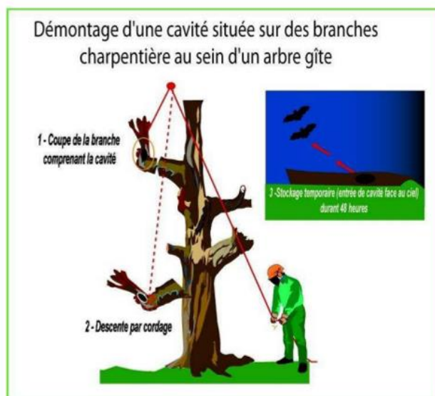
Figure 68 : Schéma présentant les précautions à prendre en cas d'abattage par démontage manuel assisté (© BIOTOPE)
