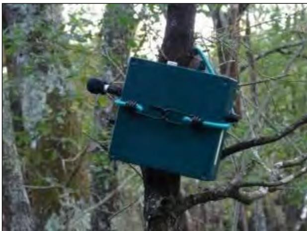
Station fixe d'enregistrement automatique des signaux de chiroptères avec système SM2BAT. Le dispositif est fixé sur un arbre. Photo : Ecosphère
