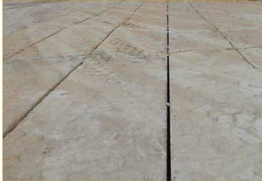
Exemple de découpe de blocs de pierre marbrée réalisée à la haveuse
