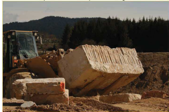
Reprise des blocs par un chargeur
