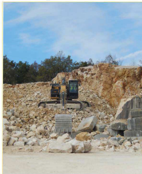
Tri des granulats et enrochements
