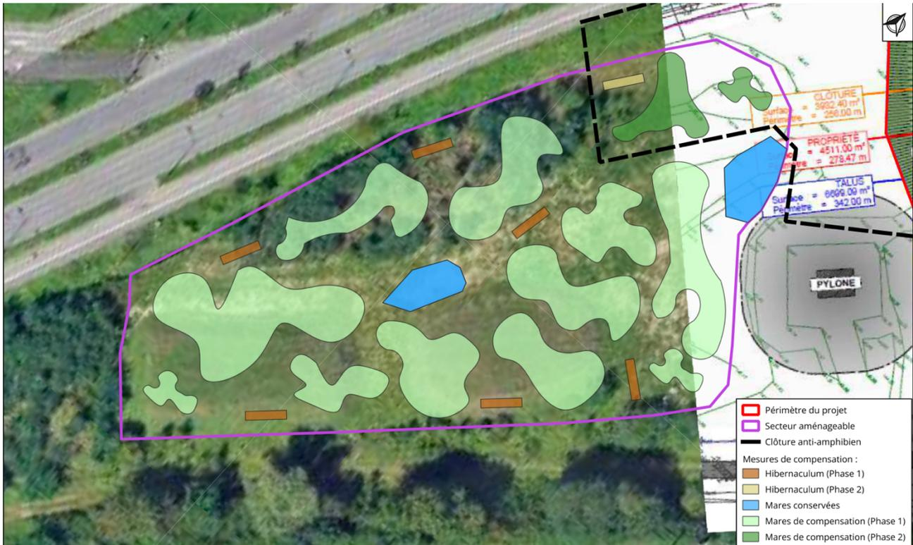
Figure 1 Proposition d'aménagement - source dossier DEP Strasbourg Électricité Réseaux
