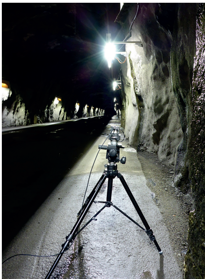
Caractérisation photométrique réalisée par le CETU (© CETU)
