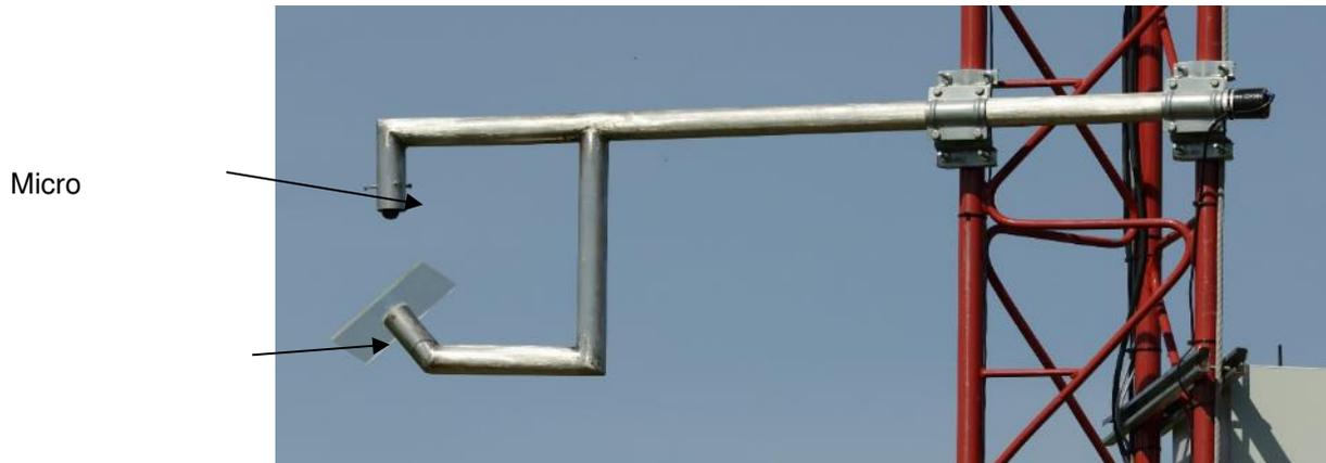
Exemples de bras de déport pour micro, fabriqués sur mesure.
