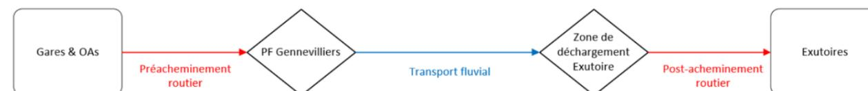
Figure 66 : Logigramme d’évacuation des déblais des fondations profondes (Source : groupement Intencités 15)
