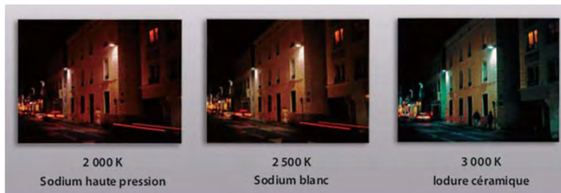
Rendu d'éclairages avec différentes températures de couleur (Source : Trame noire OFB)
