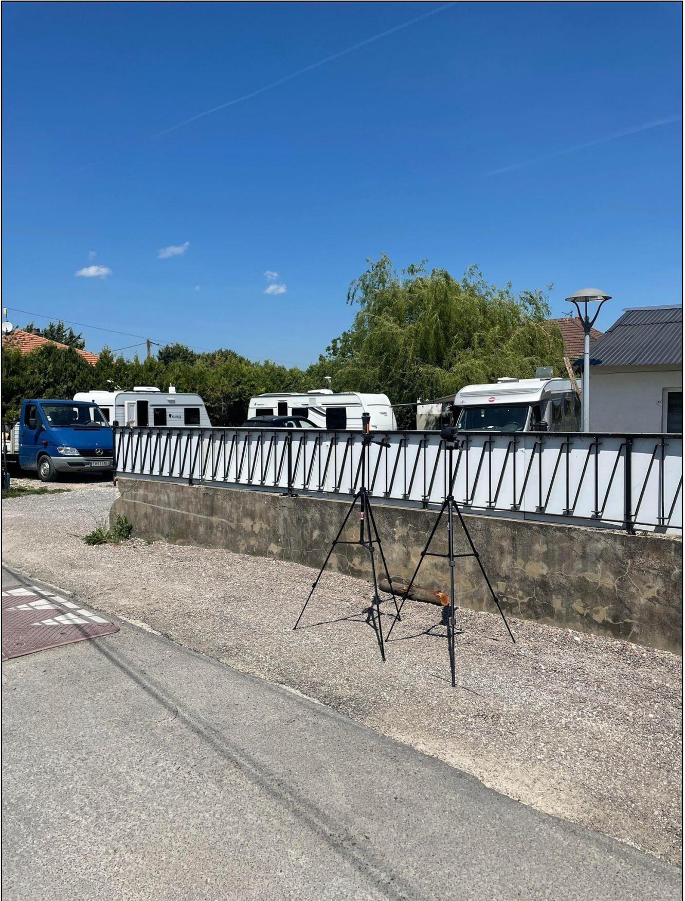
Figure 11 : Photographie du sonomètre lors de la mesure du niveau sonore en limite de ZER (point ZER-1 sur la Figure 1).
