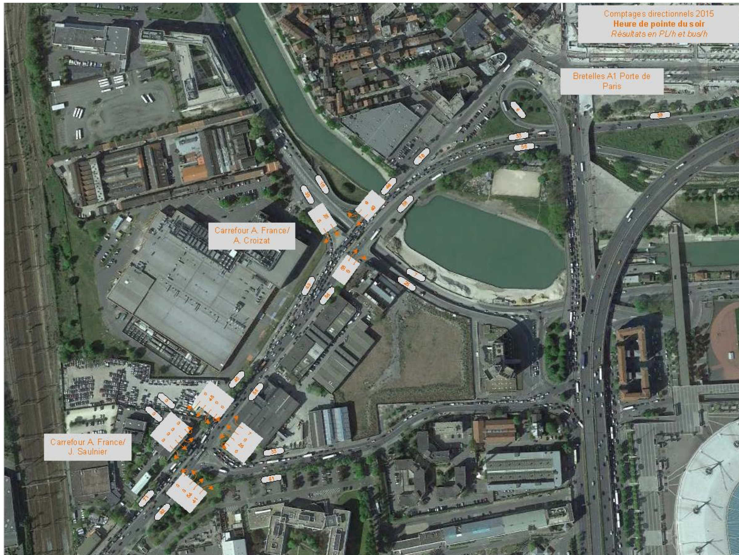
Figure 26 : Echangeur Porte de Paris – comptages directionnels 2015 – HPS en PL/h et bus/h
