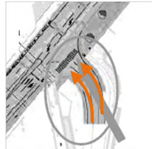
Figure 173 : Sortie de la ZAC sur 2 files sur 70 mètres
