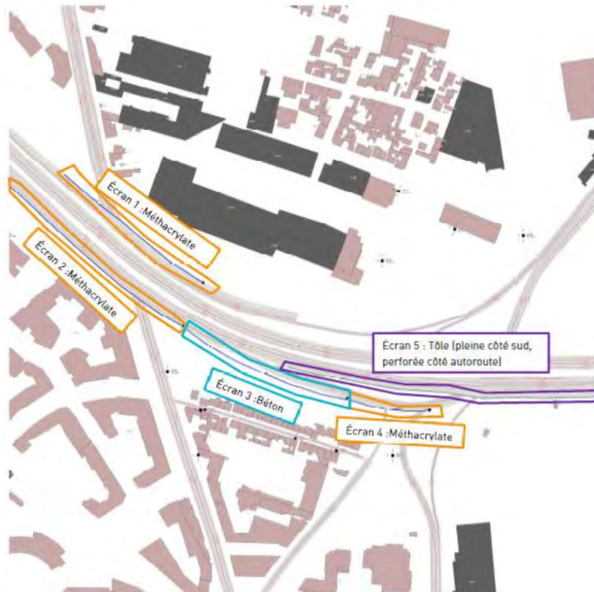
Figure 180 : Protections acoustiques déjà en place
