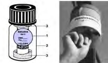
Figure 321 : Echantillonneur passif pour le BTEX (Passam)
