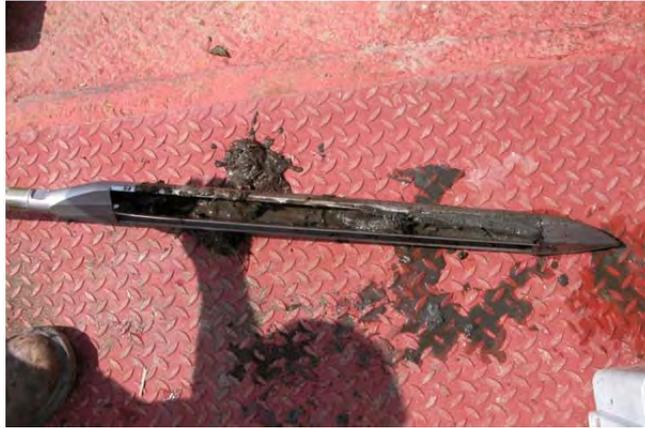
*Prélèvement avec une tarière à gouge (MIGADO ©)*
