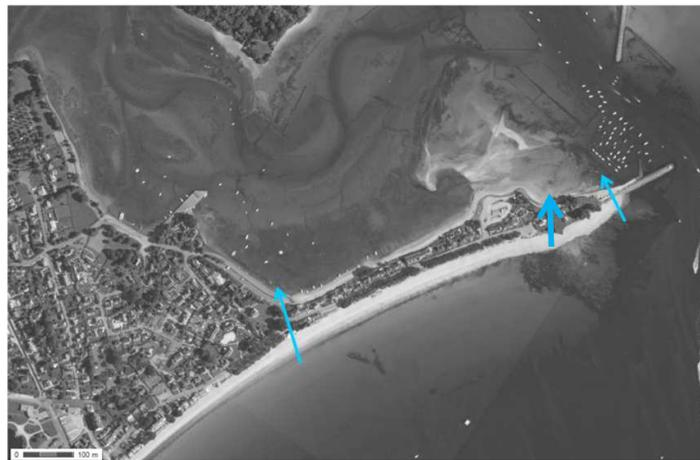
**Figure 74 : Zones de franchissement et sens des écoulements au niveau du Cap Coz (source orthophoto : Géoportail)**
