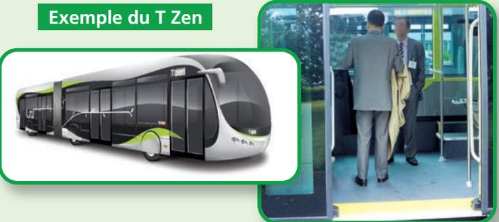
Les véhicules Tzen sont d'un accès facile pour tous. Les portes sont larges et s'ouvrent automatiquement à l'arrêt. Le plancher du véhicule est bas, au même niveau que le quai, et l'entrée se fait de plain-pied offrant ainsi aux personnes en fauteuil roulant et plus largement à toute personne ayant du mal à se déplacer ou encombrée une entrée facile.
