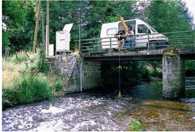
Figure 1 : vue générale d'un jaugeage avec saumon à partir d'un pont avec un camion spécialement équipé, au droit d'une station hydrométrique (photo : © Marc Sagot, DIREN Auvergne)
