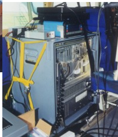
Capteur Optech ALTM 1033 à gauche, INS et récepteur GPS à droite
