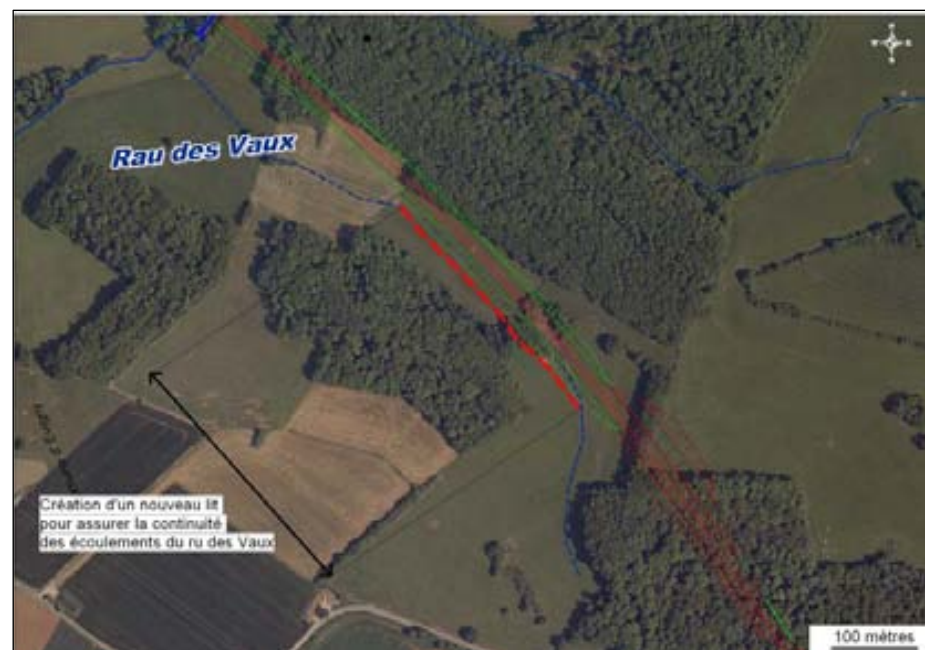
Schéma 3 : Création d'un nouveau lit pour assurer la continuité du ru des Vaux
