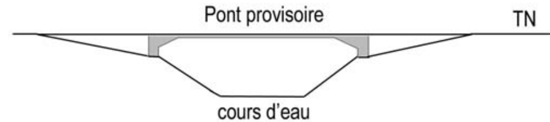
Schéma 12 : Schéma type implantation d'un pont provisoire
