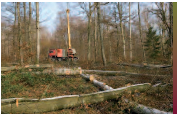
Grumes en attente d'évacuation par câble téléphérique pour une exploitation forestière respectueuse des sols.
