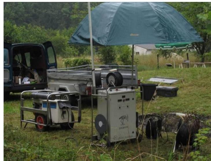
Figure 5 : Matériel de pêche électrique, au premier plan, à gauche, le groupe électrogène et à droite le boîtier servant à fournir le courant redressé (Source : Fédération de pêche de Seine et Marne)
