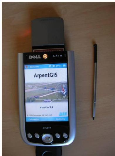
Figure 4 : GPS utilisé pour noter les informations sur le terrain
