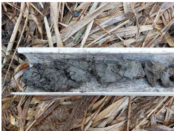
Exemple de traits réductiques dès les premiers cm de sol (s1 – Artelia, 2022)
