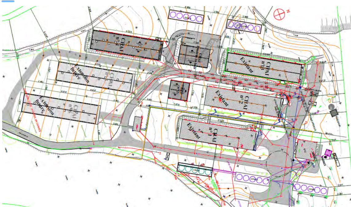
Figure 14 : Extrait du plan de masse et des réseaux pluviaux – source : Architecte DESA Mars 2022
