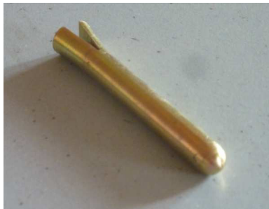
Repère (rivet) scellé à la verticale
