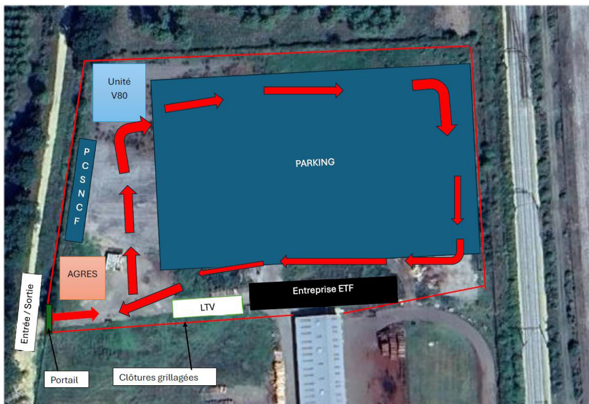
Figure 19 : Plan prévisionnel des aménagements et du PC travaux prévus sur le site de Solférino (Source : SNCF Réseau)
