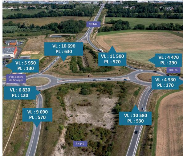
RN142 – Dénivellation des carrefours avec la RD976 et la RN151
