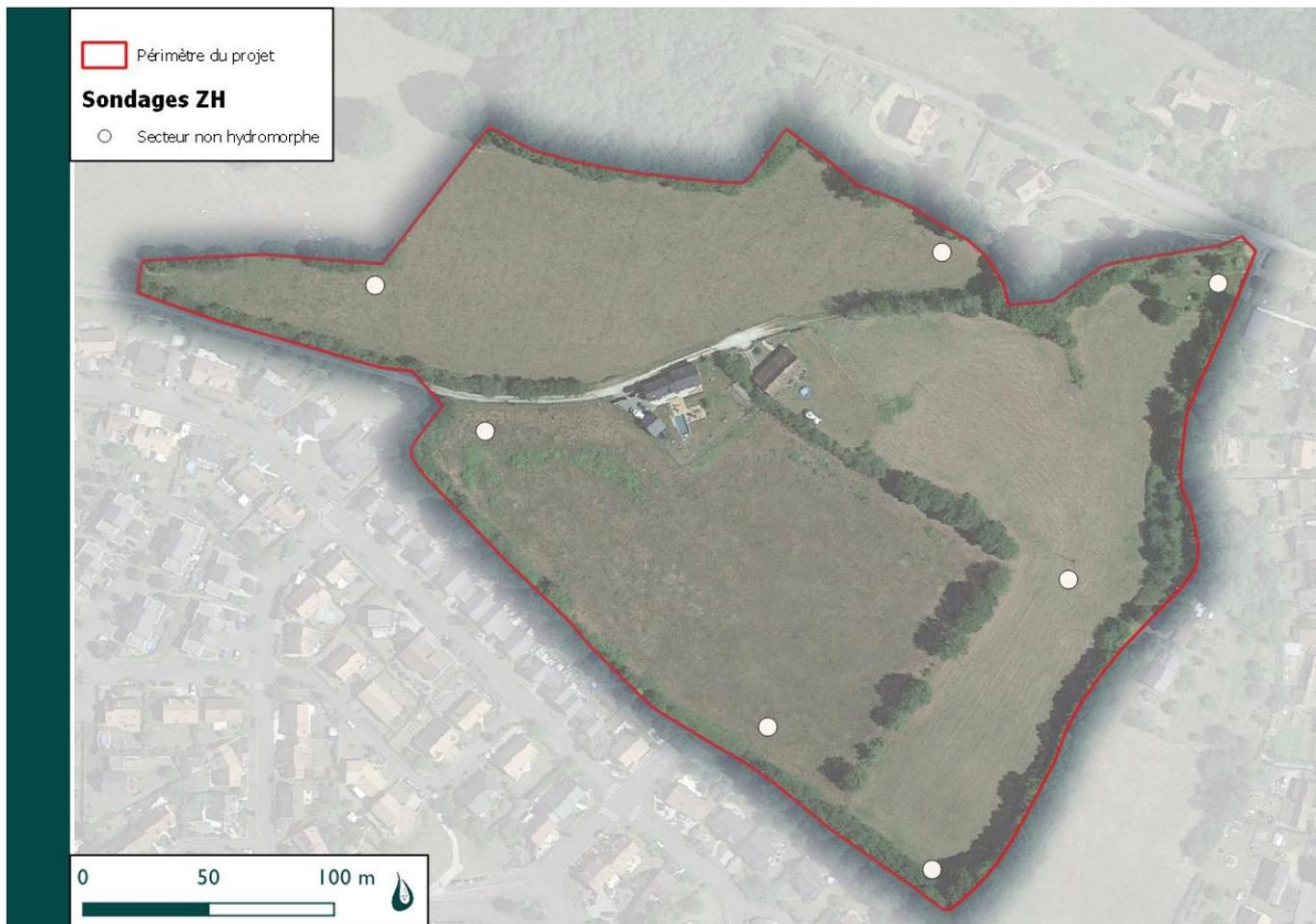
**Figure 21 : Localisation et caractéristiques des sondages pédologiques réalisés à la tarière – DMEAU 2023**
