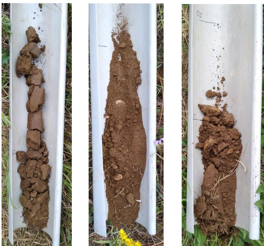
**Figure 20 : Vue des sondages pédologiques réalisés à la tarière, révélateur d'un sol non caractéristique de zones humides – DMEAU 2023**
