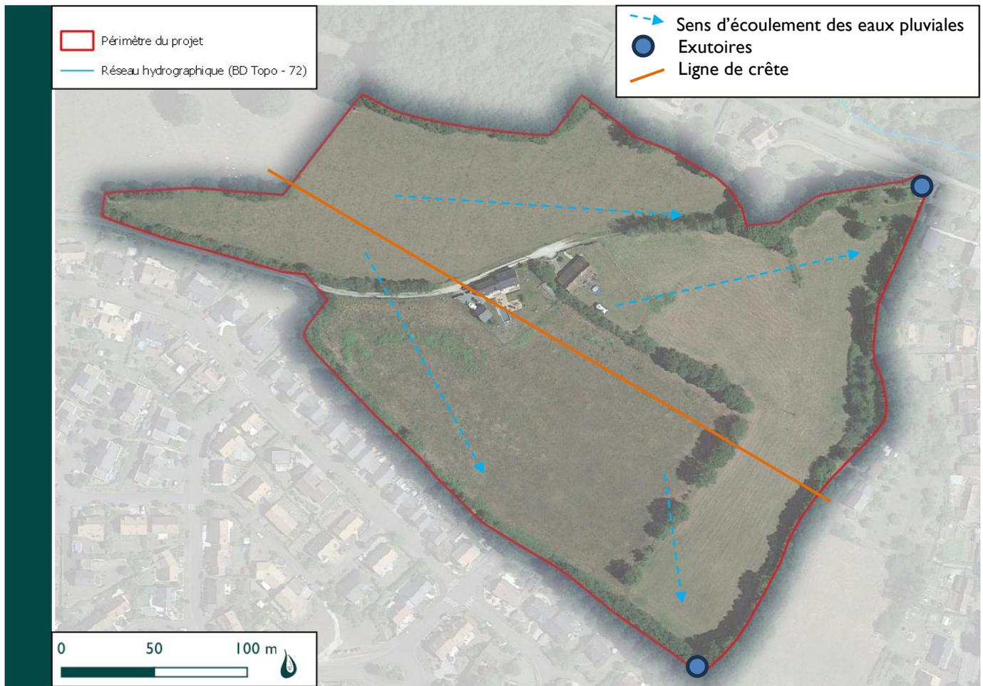
**Figure 12 : Sens d'écoulement des eaux pluviales et localisation des principaux exutoires à l'échelle du terrain d'assiette – DMEAU 2023**
